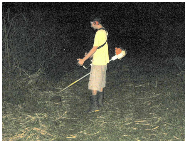
Trabalho com segurança: bota de cano longo, protetor contra ruído, óculos especiais
